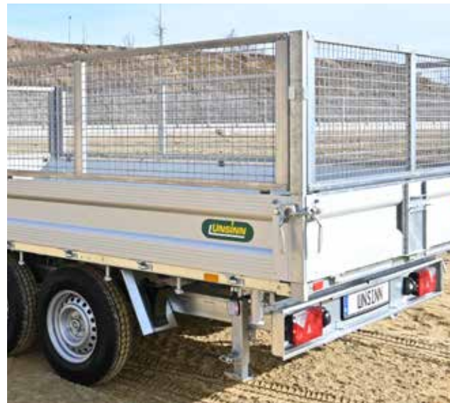
Gitteraufsatz mit integrierter Pendellagerung
