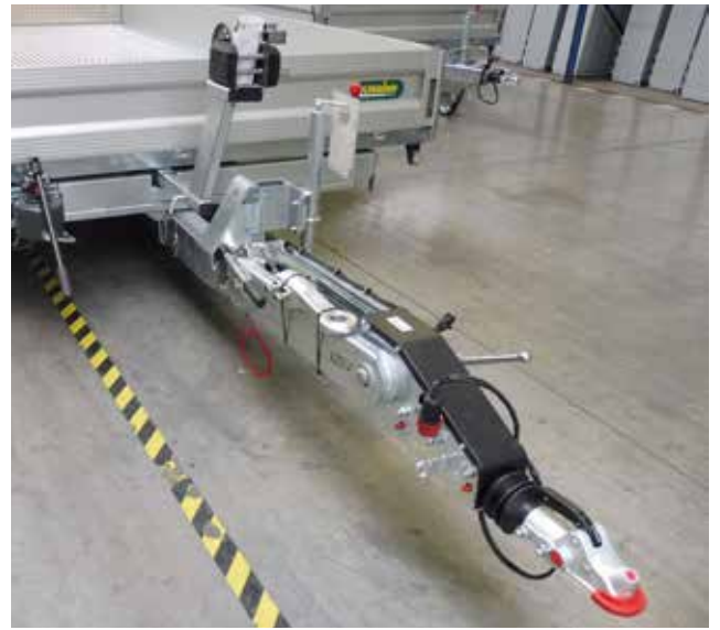
Höhenverstellbare Zugdeichsel (HVZD)
