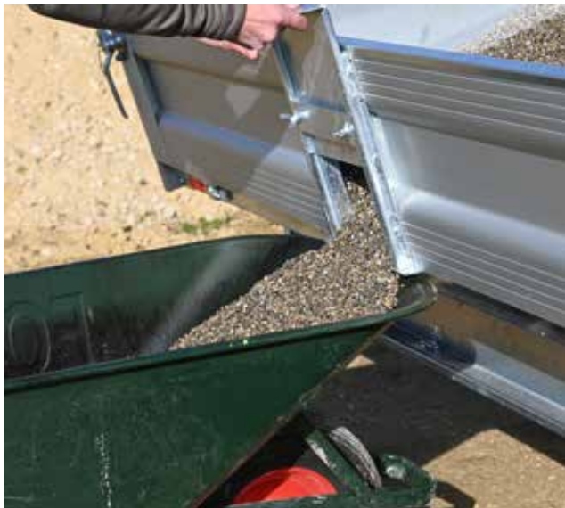
Kornschieber für dosiertes Abladen
