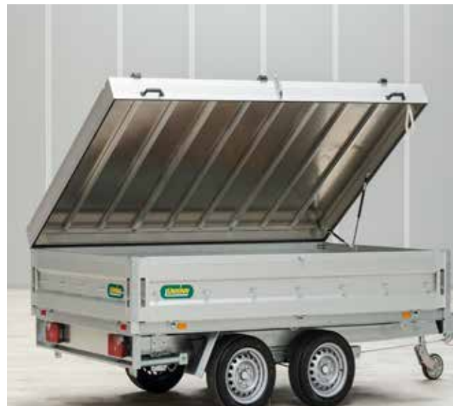
Deckel aus Aluminium für den Schutz des Ladeguts
