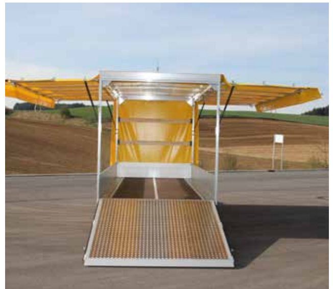
Hochlader Typ UH mit Planenaufbau und Auffahrklappe
