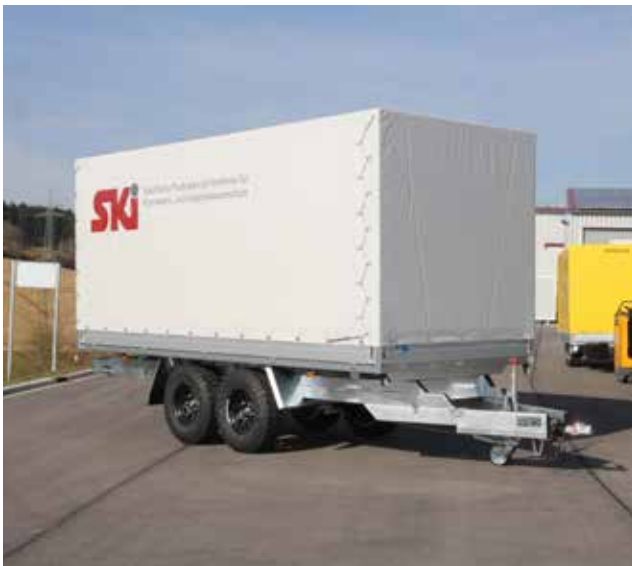
Planenaufbau und Offroadbereifung Typ UH
