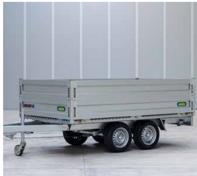
Bordwandaufsatz für mehr Ladevolumen
