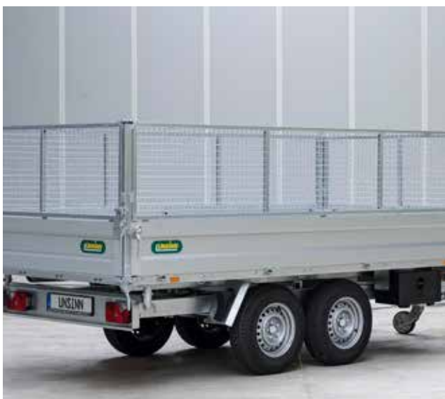
Gitteraufsatz pendelnd gelagert für mehr Ladevolumen
