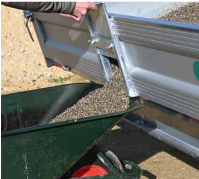
Kornschieber für dosiertes Abladen
