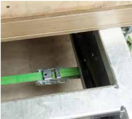
Bodenplatte mithilfe von Spanngurten am Rahmen gesichert
