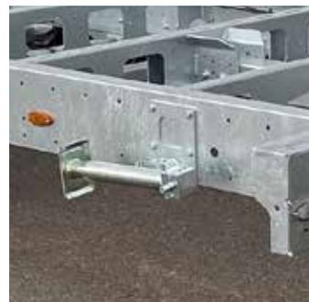
Kurbelstützen in Fahrstellung (links) bzw. eingefahren (rechts)
